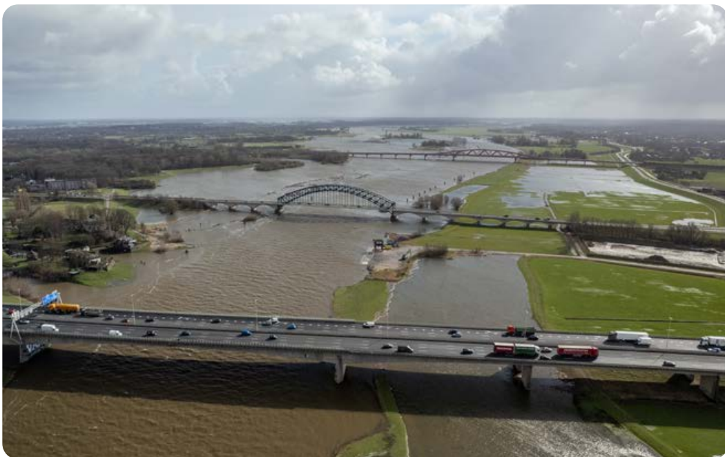
Rivierverruiming langs de IJssel draagt bij aan de afvoer en bergingscapaciteit, waardoor het overstromingsrisico wordt beperkt. De uiterwaarden bieden niet alleen ruimte voor water, maar ook voor planten, dieren en mensen (gemeente Zwolle).
